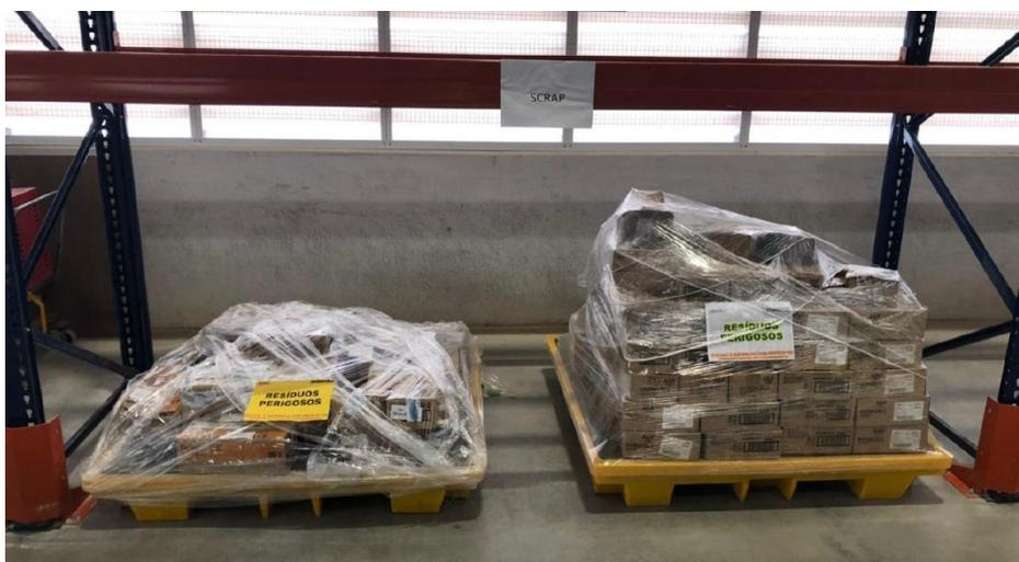
**Figura 3. Área de armazenamento de pilhas e baterias inservíveis, com pallets de contenção.**
