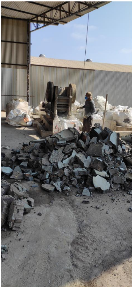
Figura 17. Britador de escórias do empreendimento.
