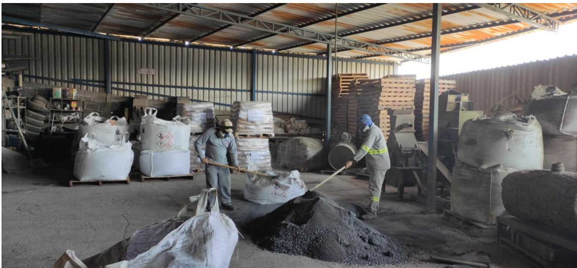
Figura 5. Mistura manual das matérias-primas e preparação da areia bentônica para os moldes.
