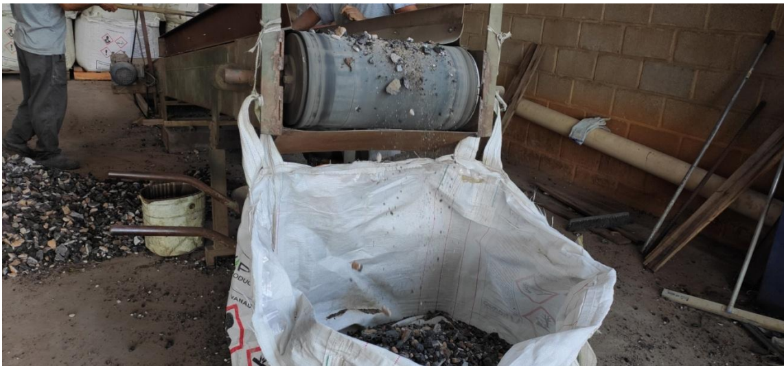
Figura 10. Esteira pós - britador do empreendimento.
