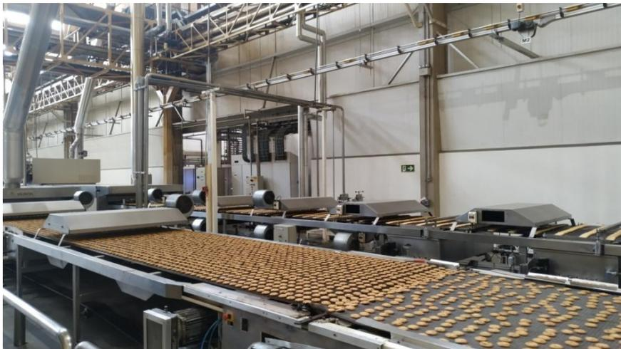
**Figura 1. Vista geral da linha de fabricação de biscoitos/cookies.**
