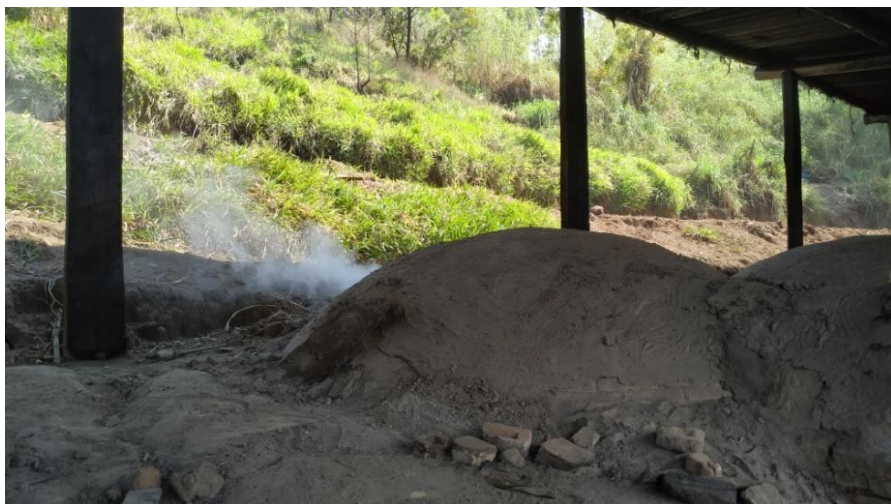
Figura 3. Emissão atmosférica da operação dos fornos (carbonização da lenha).
