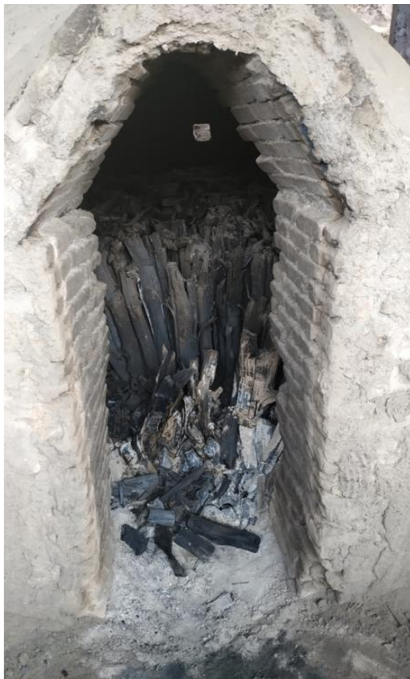
Figura 4. Forno aberto após processo de carbonização.
