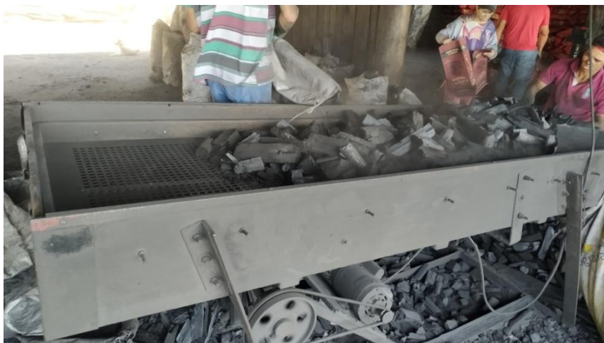
Figura 7. Peneira classificadora de pedaços de carvão.
