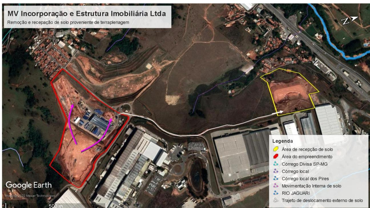
**Figura 4. Áreas de corte, aterro e disposição de solo proveniente do processo de terraplanagem**
