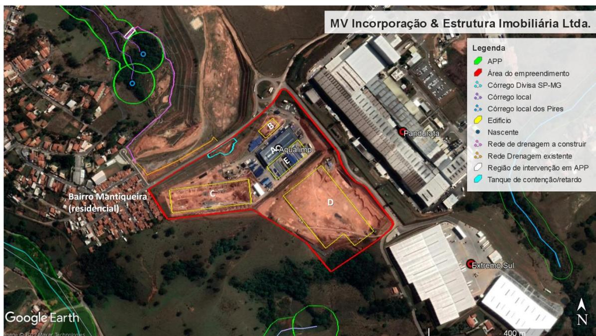
**Figura 3. Localização do empreendimento, com destaque para localização dos edifícios, trajeto de lançamento de drenagem proposto, cursos hídricos e respectivas áreas de preservação permanente (APP).**
