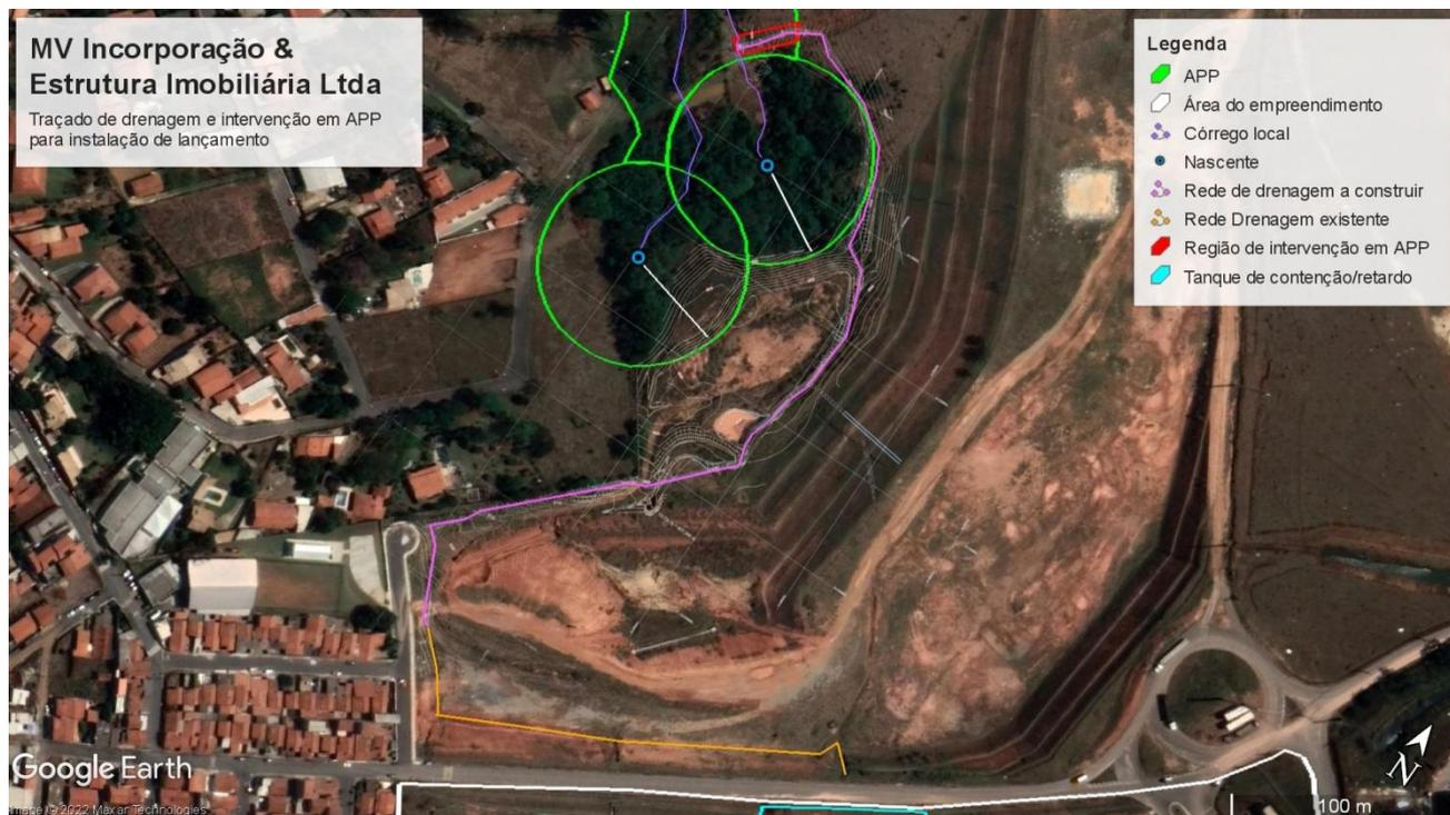
**Figura 5. Projeto de extensão da rede de drenagem até o ponto de lançamento final, com delimitação da APP e intervenção necessária.** Fonte: Google Earth (2021) / Informações complementares
