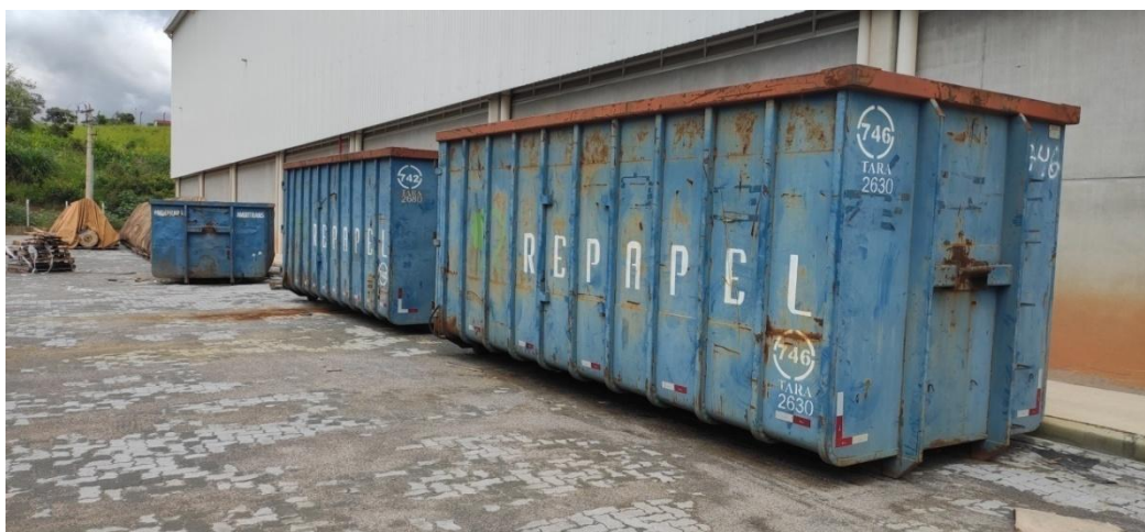
Figura 13. Container meálico de armazenamento transitório de resíduos.
