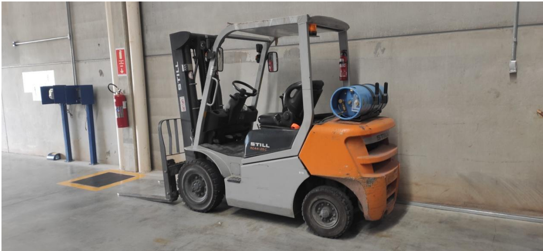
Figura 7. Empilhadeira a gás utilizada para movimentação externa de produtos no empreendimento.
