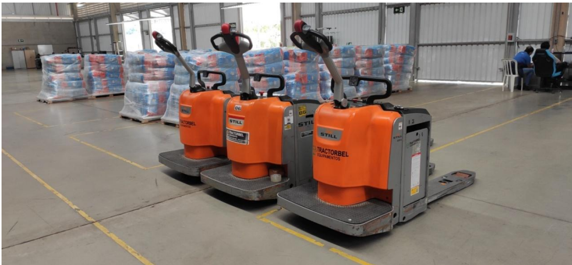
Figura 8. Empilhadeiras elétricas utilizadas para movimentação interna de produtos.
