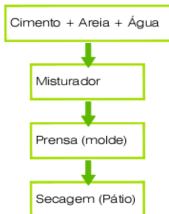
Figura 2. Fluxograma do processo produtivo.
