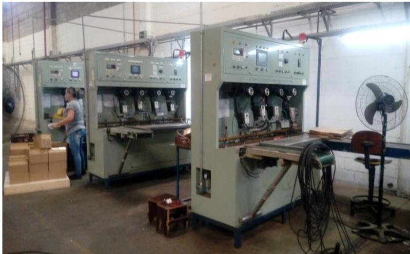
Figura 2. Maquinários de teste de baterias
