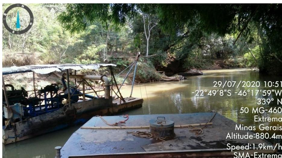
Figura 6. Próximo do ponto a montante do limite de dragagem do empreendimento. Presença, à esquerda, da draga móvel de sucção do material mineral do leito do rio.
