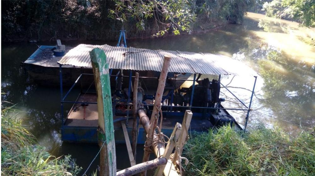
Figura 1. Draga Fixa (a diesel), utilizada para sucção de polpa minerada.
