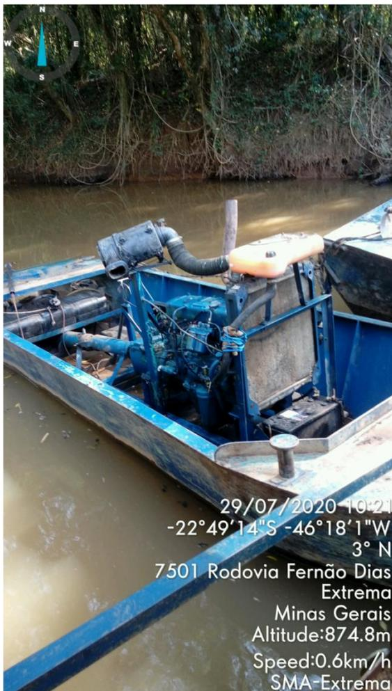
Figura 2. Barco rebocador a diesel.
