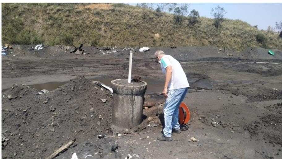
**Figura 5. Vista de um dos piezômetros instalados no aterro.**
