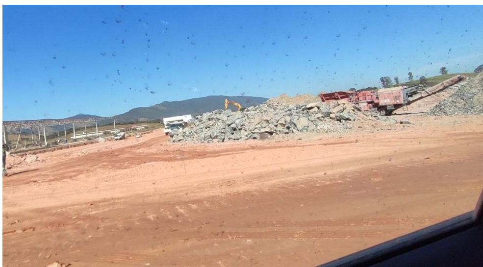
Figura 36. Área de britamento das rochas detonadas.
