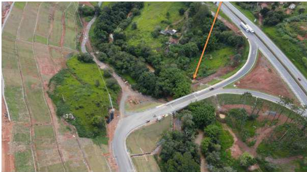
Figura 10. Fotografia aérea feita com o uso de drone, que representa o resultado da intervenção realizada em área de preservação permanente para construção do acesso ao empreendimento.
