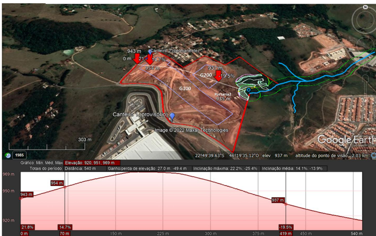
Figura 8. Avaliação da topografia após finalização da terraplanagem, para ligação da rede interna de esgotamento sanitário do condomínio logístico (adaptado).
