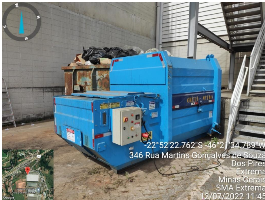
Figura 12. Caçamba compactadora de resíduos orgânicos – Área externa
