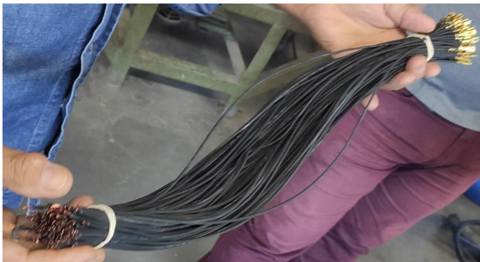
Figura 5. Chicotes elétricos (não acabados)
