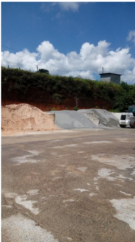
Figura 1. Bais de armazenamento de agregados (areia e brita).
