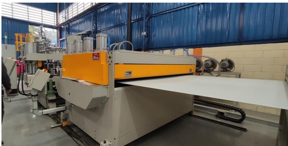
Figura 7. Saída da área de aquecimento e corona, entrando para área de resfriamento e corte. Fonte: SMA
