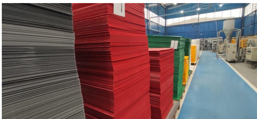
Figura 9. Armazenamento transitório de produto gerado da moldagem. Fonte: SMA
