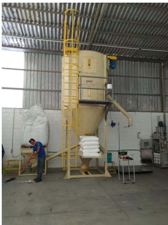
Figura 2. Silo para mistura de matéria prima (polietileno)
