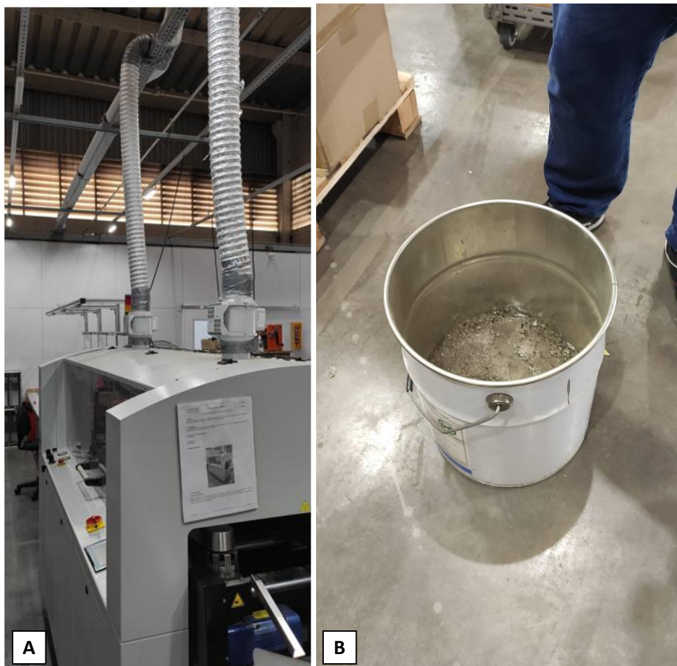
Figura 5 . Maquinário de solda-onda, com exaustores vinculados a saída única (A) e resíduo de solda acumulado do processo (B)
