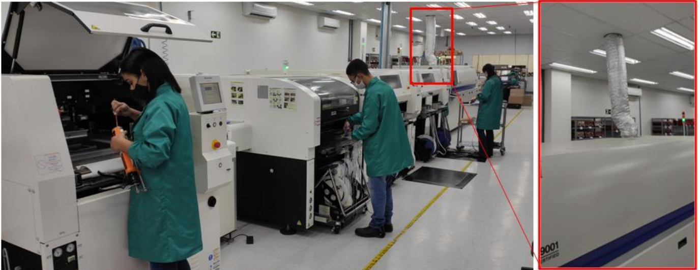
Figura 4 . Área de montagem automatizada de placas eletrônicas, com foco para o exaustor do forno de aquecimento/solda
