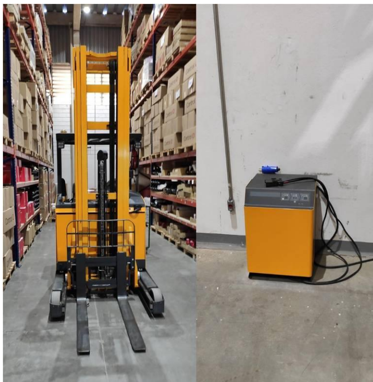
Figura 8. Empilhadeira elétrica utilizada e ponto de recarga
