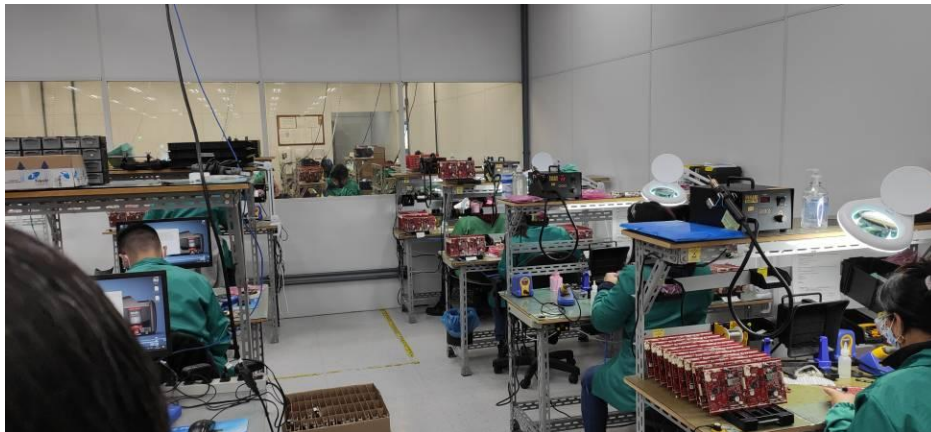
Figura 6. Linha de montagem manual de placas e programação do firmware
