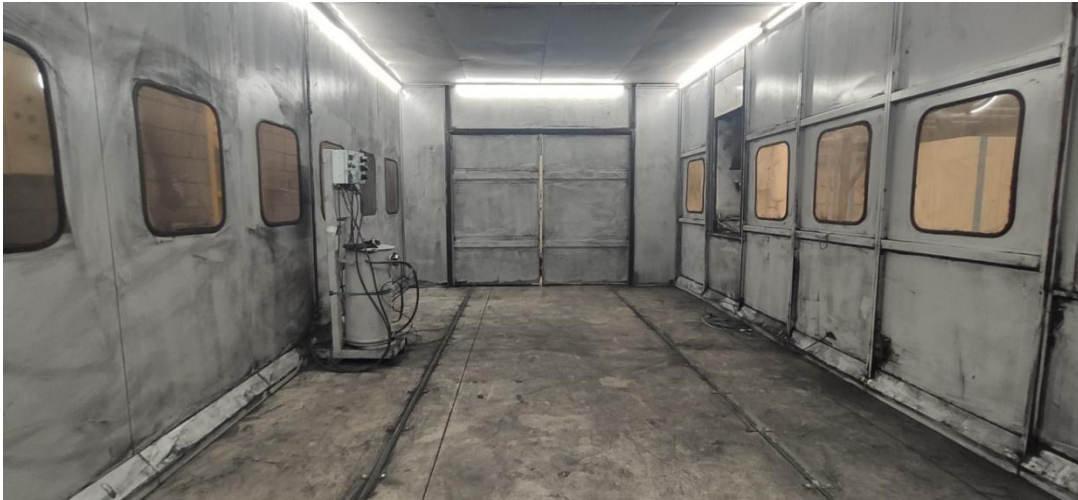
Figura 12. Interior cabine de pintura de peças grandes.
