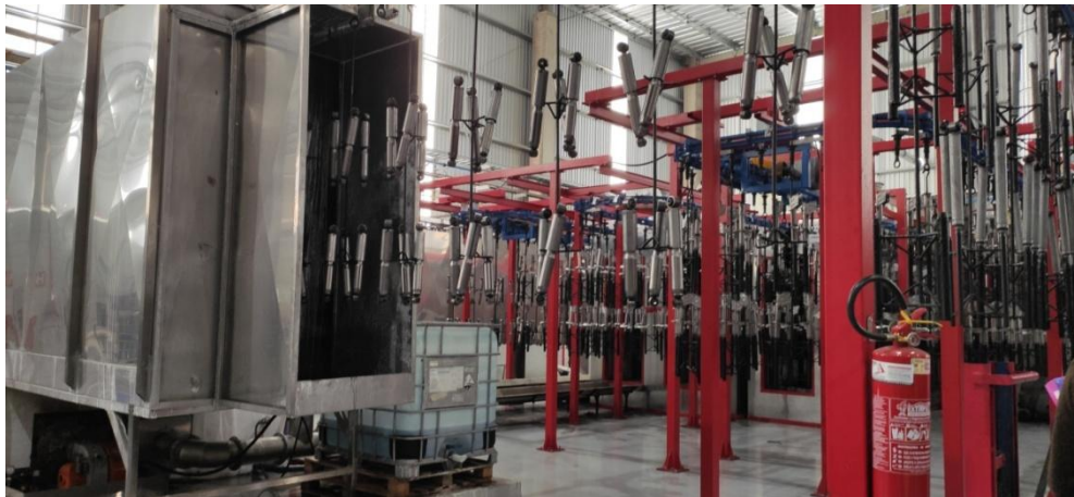
Figura 7. Linha de Pintura com evidência da estufa de secagem.
