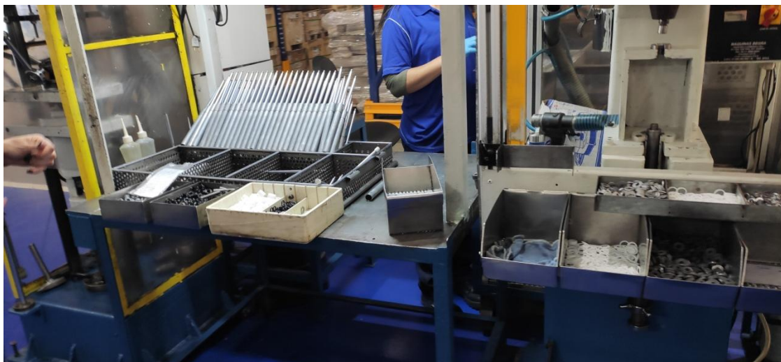
Figura 5. Linha de montagem do conjunto pistão/haste do amortecedor.
