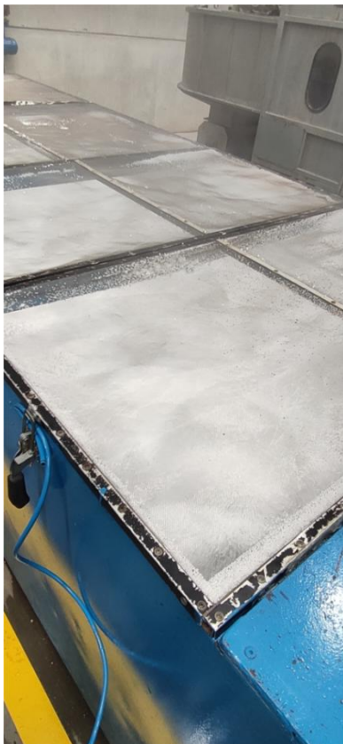
Figura 8. Caixas com sopradores/ventiladores para secagem do material.
