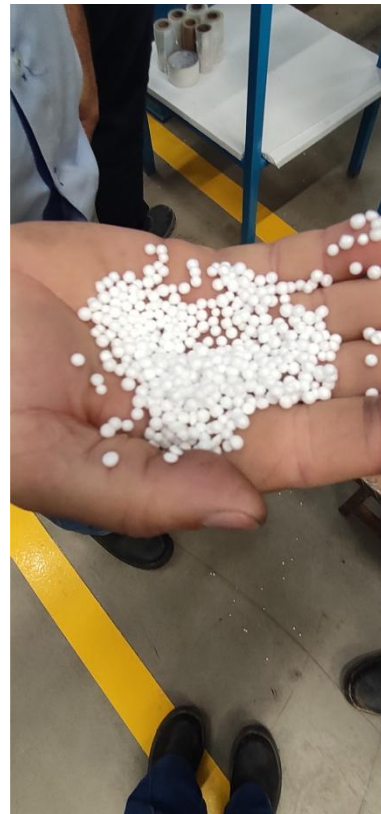
Figura 7. EPS pós expansão.
