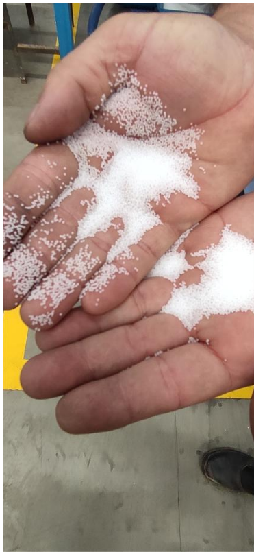
Figura 6. EPS pré expansão.
