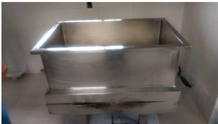
Figura 3. Tanque de Fabricação de queijos.
