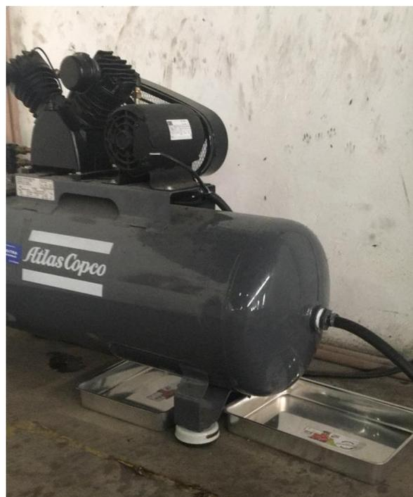
Figura 10. Área do compressor, com bacia de contenção
