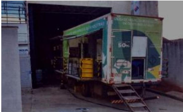
**Figura 9. Unidade móvel de regeneração de óleos industriais contratada pelo empreendimento para execução do processo de re-refino de óleo.**
