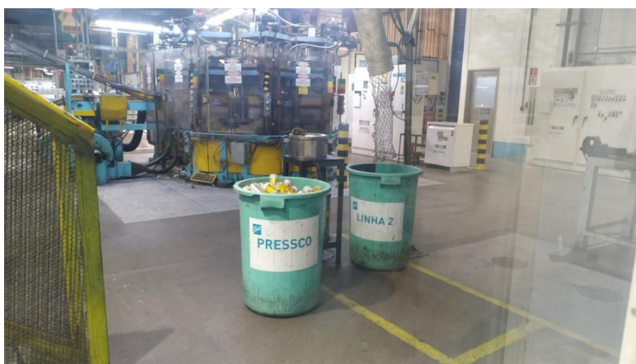
Figura 8. Vista de maquinário das etapas finais de conformação do “pescoço” das latas e evidência de coleta de refugos/produtos com avarias.
