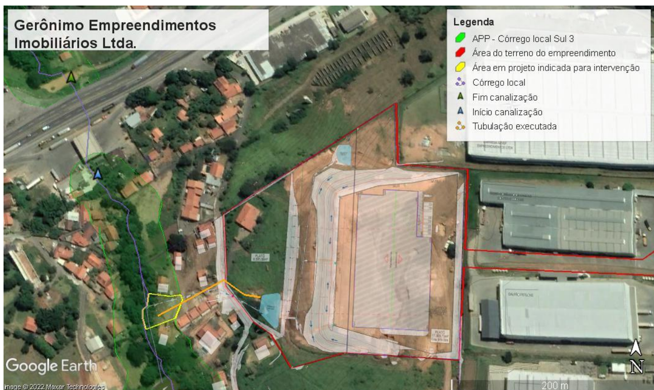
Figura 6. Projeto de extensão da rede de drenagem até o ponto de lançamento final, com delimitação da APP e intervenção necessária. Fonte: Google Earth (2022)
