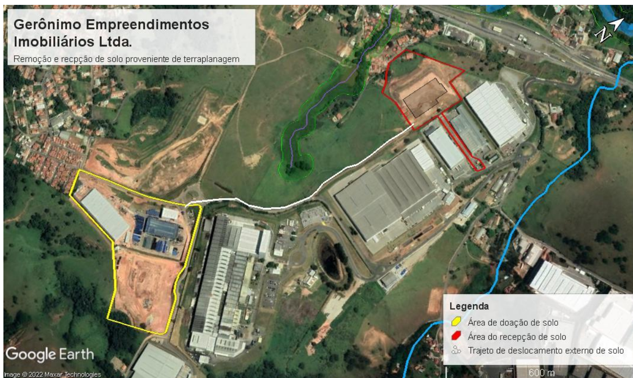
Figura 5. Áreas de corte, aterro e disposição de solo proveniente do processo de terraplanagem
