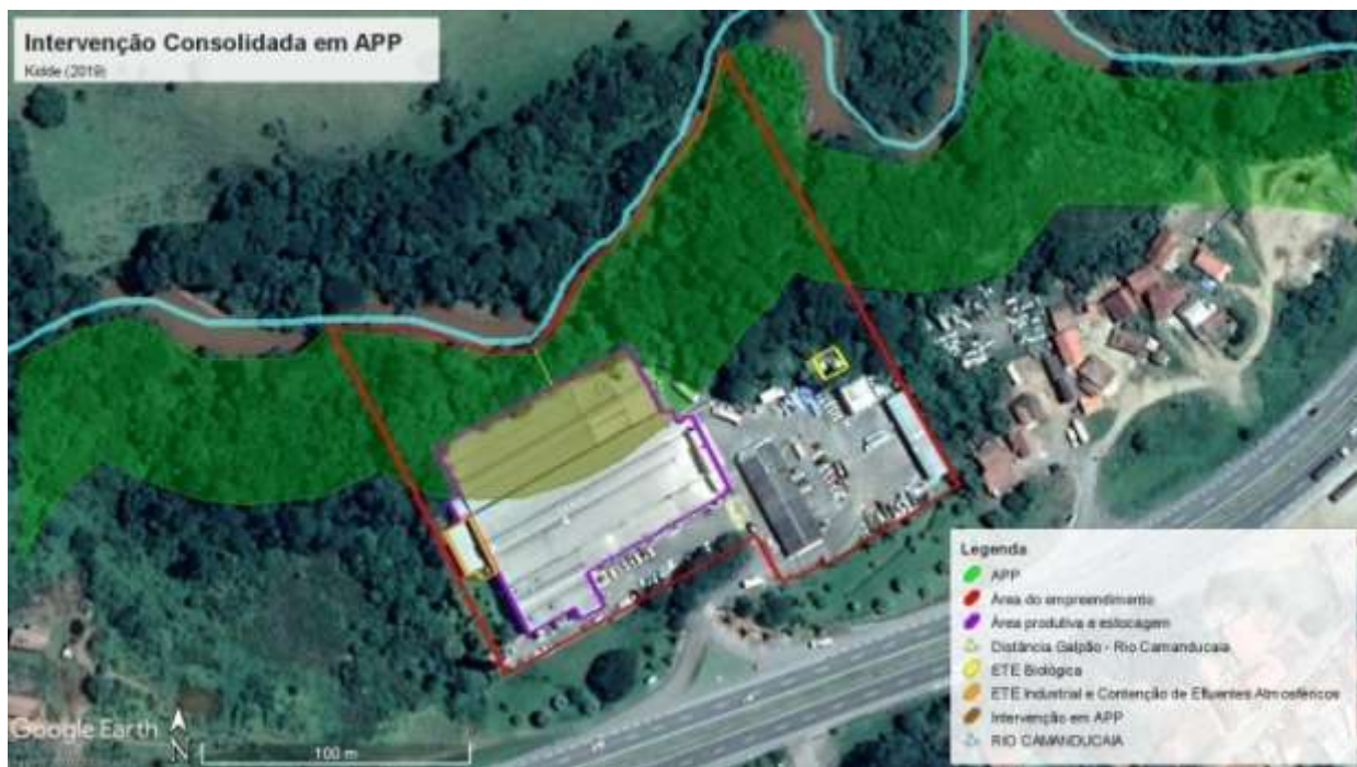
Figura 4. Delimitação da faixa marginal de 50 metros referente à Área de Preservação Permanente – APP do Rio Camanducaia e sobreposição da área de intervenção do empreendimento. Fonte: Google Earth (2019).
