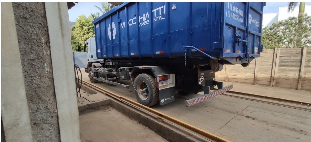
Figura 4. Balança de pesagem rodoviária.
