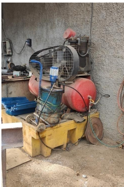
Figura 8. Compressor utilizado para encher pneus
