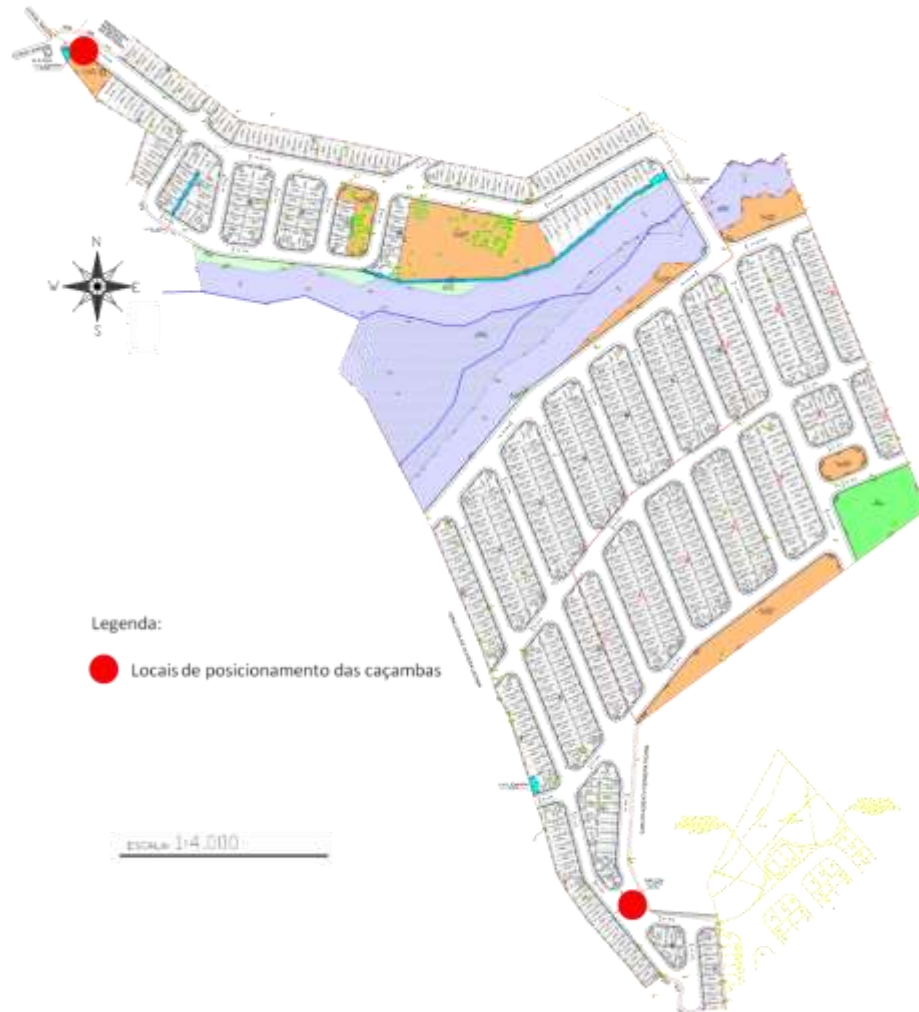
Figura 5. Definição do posicionamento das caçambas para recolhimento de resíduos sólidos gerados até atingir taxa de ocupação dos lotes superior a 50%
