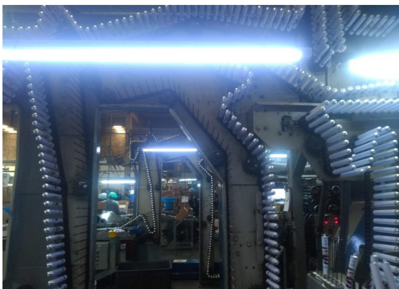
Figura 6. Detalhe dos tubos entrando e saindo das estufas de secagem de esmalte e impressão litográfica
