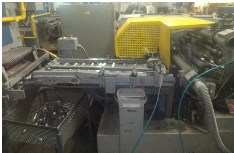
Figura 5. Conformação em tubos de alumínio, com detalhe para cesta coletora de refugo.
