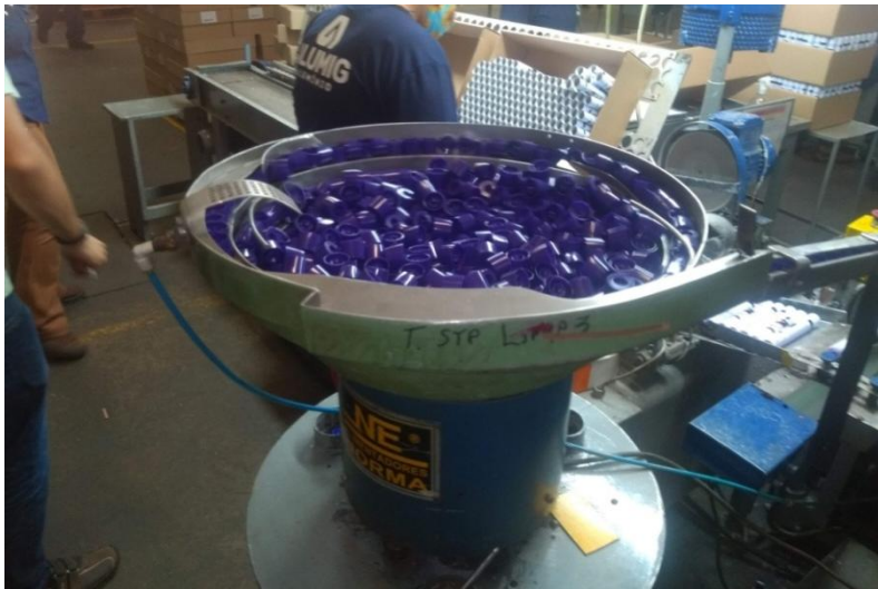
Figura 7. Detalhe de estrutura de envio das tampas para rosqueamento no tubo e embalagem dos produtos acabados em caixas
