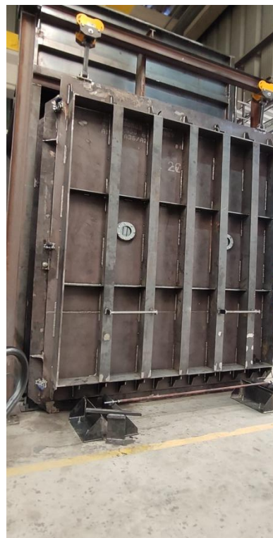
Figura 8 . Autoclave para inserção do óleo vegetal.
