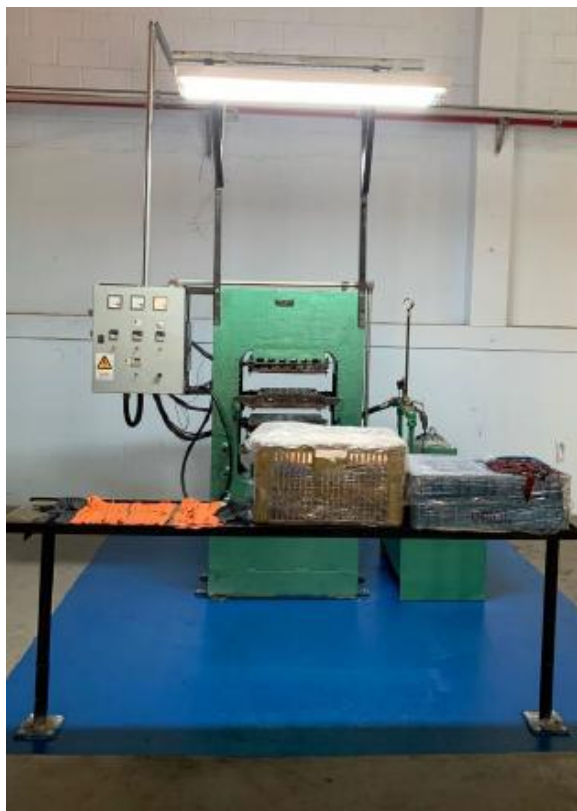
Figura 8 . Prensa de produção alocada sobre piso impermeável com pintura epoxi e revestimento em resina, para evitar absorção de óleos.
