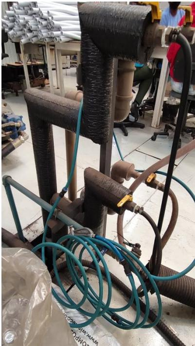
Figura 6. Sistema de resfriamento das máquinas injetoras
