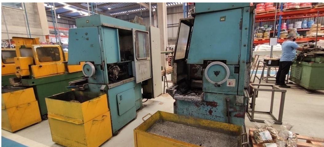
Figura 5. Tornos para fabricação das peças metálicas.
