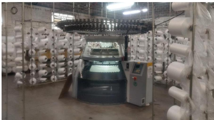
**Figura 3. Tear circular presente na área de tecelagem**
