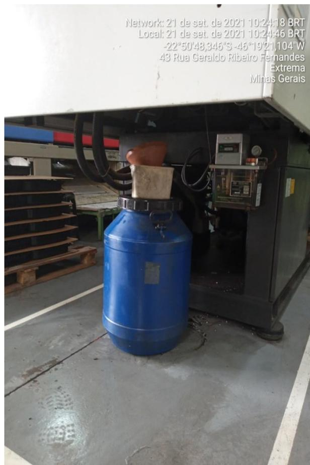
**Figura 8. Tanque para armazenamento de óleo das injetoras**
