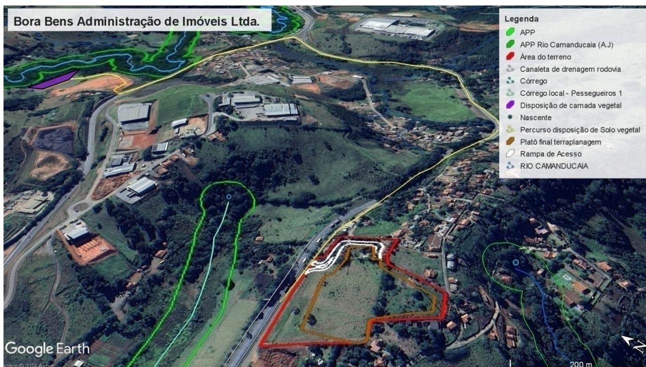
Figura 9. Áreas de execução de terraplanagem e de disposição de solo (bota-fora)
